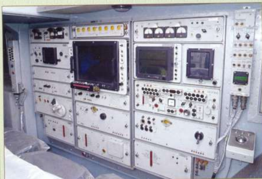
▶ Stanowiska operatorów PRWB T381 – na wszystkich pulpitych zamontowane zostały nowe wyświetlacze ciekłokrystaliczne. Wąski panel z małym wyświetlaczem po prawej stronie to blok sterowania dalmierzem laserowym.
