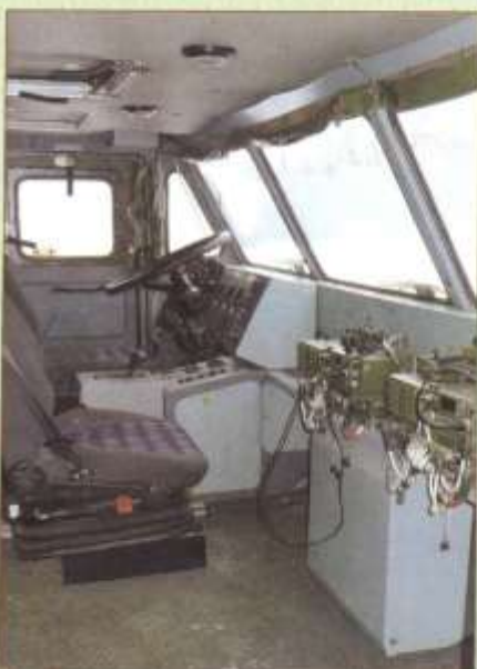
Ogólny widok na stanowisko kierowcy PRWB T381, dobrze widoczne są dwie radiostacje. Panel sterowania systemami podwozia, który zamontowano po lewej stronie deski rozdzielczej kierowcy.
