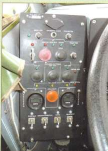
Ogólny widok na stanowisko kierowcy PRWB T381, dobrze widoczne są dwie radiostacje. Panel sterowania systemami podwozia, który zamontowano po lewej stronie deski rozdzielczej kierowcy.
