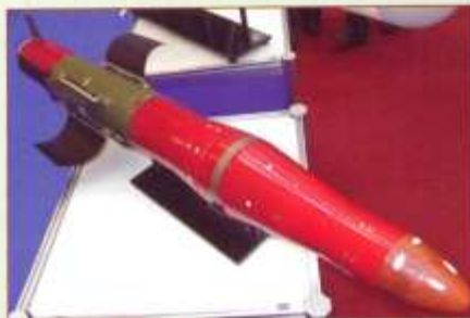
Przeciwpancerny pocisk kierowany RK-2 zestawu R-2 Barrier.
