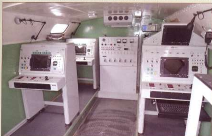
➔ Widok ogólny wnętrza kontenera wozu dowodzenia A31 – po prawej widoczne stanowisko dowódcy z wysuniętą klawiaturą oraz dodatkowym wyświetlaczem u góry, po lewej rozmieszczono dwa stanowiska operatorów, pośrodku widać skrzynkę rozdzielczą, a u góry blok klimatyzacji i filtrowentylacji. Na fotografiach po prawej widać szczegóły systemu sterowania konsolą z tablicami sygnalizacyjnymi i symboliką na nich, specjalnie rozmieszczonymi przyciskami oraz joystickiem i manipulatorem kulowym.
