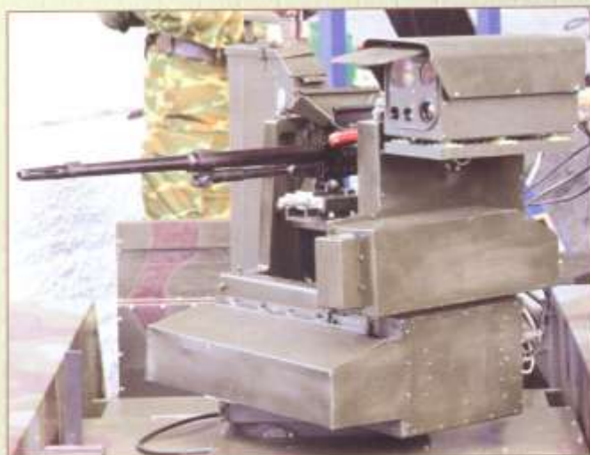
↑ Zdalnie sterowane stanowiska strzeleckie Adunok , które mogą być dołączone do modułów bojowych A32 w ramach zestawu A3 - z 7,62 mm km KT-7,62...
