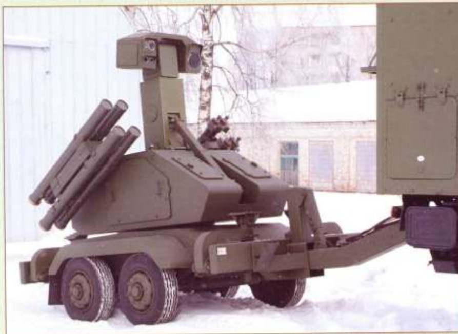
Moduł bojowy A32 w położeniu marszowym, dołączony do pojazdu holującego.
