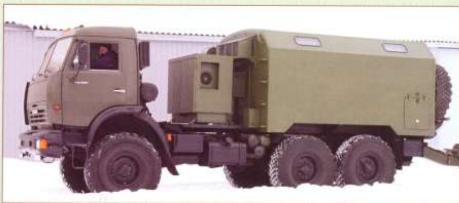
➔ Pojazd stanowiska dowodzenia A31. Pomiędzy kontenerem a kabiną kierowcy widać agregat prądotwórczy.
