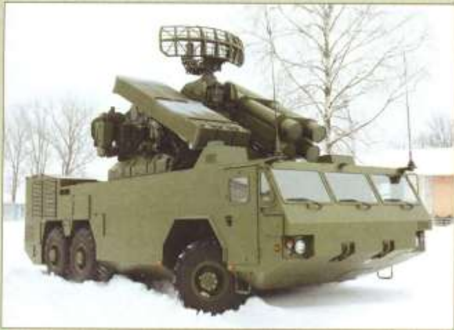
Przeciwlotniczy raketowy wóz bojowy T381 zestawu T38 Stilet może wykorzystywać tak pociski raketowe 9M33M2/3 oraz nowe, znajdujące się w fazie rozwoju, T382.
