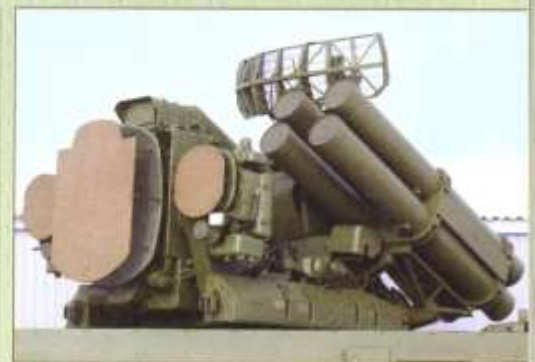
Moduł bojowy PRWB T381 z dwoma podwójnymi pakietami makiet pojemników pocisków T382.
