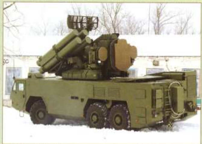
Przeciwlotniczy raketowy wóz bojowy T381 zestawu T38 Stilet może wykorzystywać tak pociski raketowe 9M33M2/3 oraz nowe, znajdujące się w fazie rozwoju, T382.
