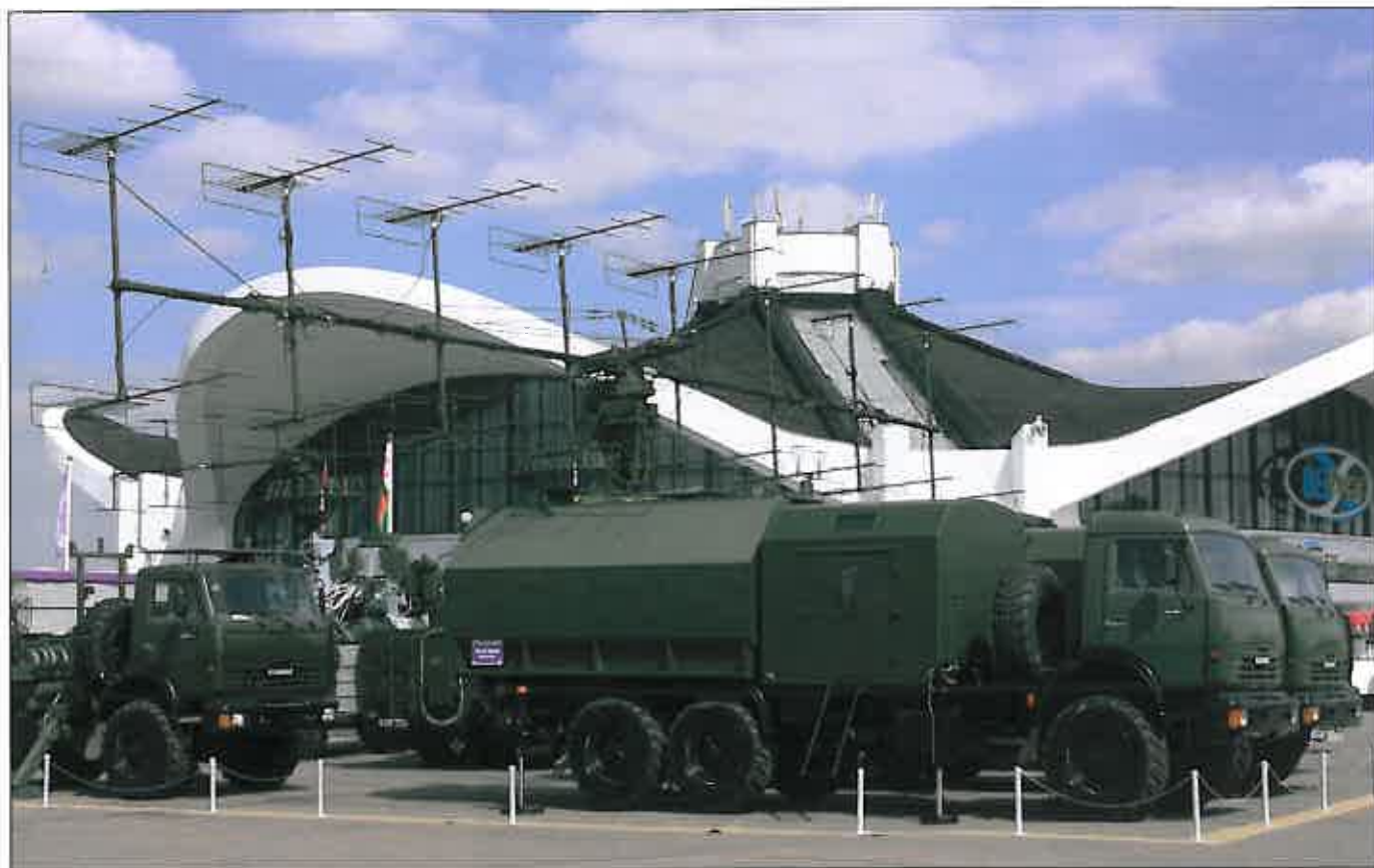
↑ Stacja radiolokacyjna pasma metrowego TRS-2D (jednostka antenowo-aparaturowa i stanowisko dowodzenia na samochodach ciężarowych) zaprezentowana podczas mińskiej wystawy Milex-2009.
